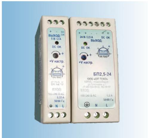
**Блоки питания БП2-5, БП2,5-24** - обеспечивает преобразование переменного тока в стабилизированное питание постоянного тока для датчиков, сенсоров и устройств системы «Контроль», а также приборов других производителей.
