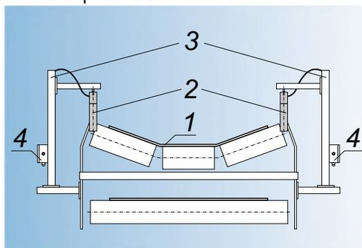
На кронштейны (3) закрепленные с каждой стороны конвейера, вертикально, монтируются по одному датчику (2), на границе допустимого положения края ленты ( $S=10\%$  от ширины конвейерной ленты) и клеммные коробки (4). Выход ленты (1) из допустимой зоны приводит к наклону датчика. Отклонение датчика от вертикальной оси свыше заданного угла ( $30^\circ$ ) вызывает изменение его логического сигнала – режим «авария».
