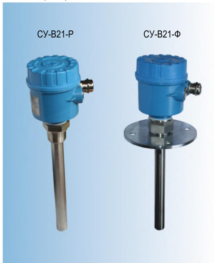
Чувствительным элементом сигнализатора является вибрационный зонд в виде стержня, на который воздействует пьезоэлектрический элемент, вызывая его механическое колебание. При демпфировании зонда материалом, амплитуда его колебания резко снижается, а изменение регистрирует собственная оценочная схема, управляющая контактами выходного реле.
