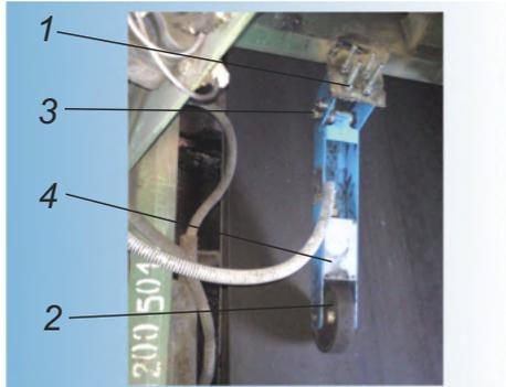
Устройство контроля скорости УКМС устанавливается на холостую ветвь конвейера, крепеж (1) входит в комплект поставки. Для обеспечения полного прилегания колеса (2) устройства к ленте с необходимым усилием, изделие снабжено пружиной сжатия с блоком регулировки (3).
